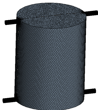
Рис.3. Буферный бак с расчетной сеткой: объем V=1 \text{ м}^3 , диаметр D=1 \text{ м} , высота H=1,28 \text{ м}
